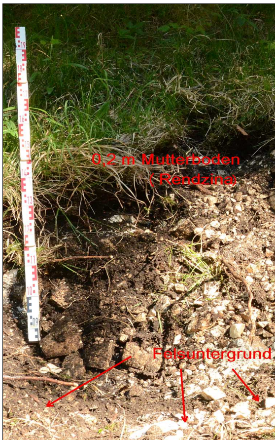
Abbildung 12: Foto Bodenaufschluss Schurf Nr. 7 mit Benennung der angetroffenen Bodenschichten
