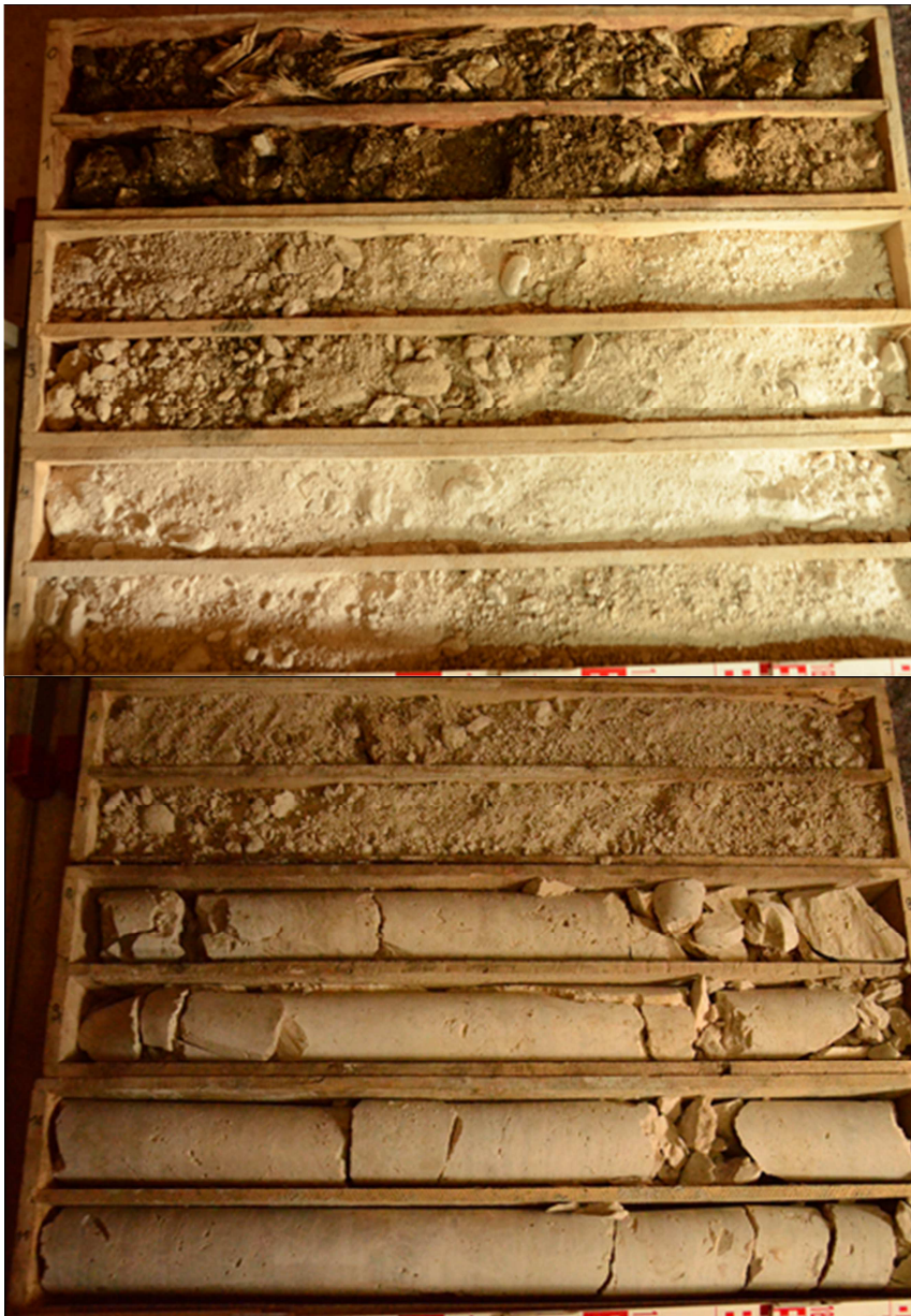
Abbildung 4: Bohrkern BK 7 von 0,0 bis 12,0 m, oberhalb des Grundwasserspiegels
